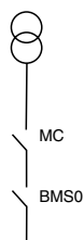
Selektivitätsgrenzstrom I_s [kA] für Selektivität zwischen BMS0-D... und MC... (Überlast- und Kurzschlussauslöser MC.. auf max. Wert einstellen)
